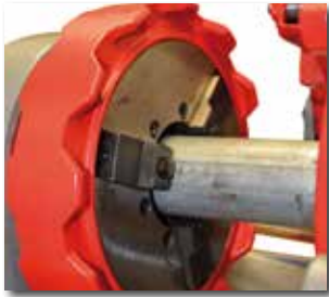
Garra de auto-travamento (2 pontos de aderência por garra), facilmente substituíveis.
