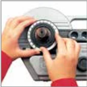
Ajuste do ângulo da curva sem necessidade de ferramentas
