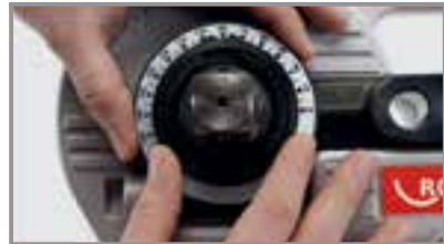
Pré-ajuste do ângulo de dobra sem utilização de ferramentas
